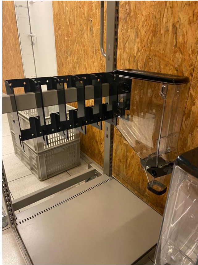
Abbildung 5: Vorrichtung zum Befüllen und Reinigen der Bins
