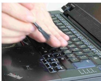
Entfernung von Schmutz aus der Tastatur durch Umdrehen und mit Pinsel
