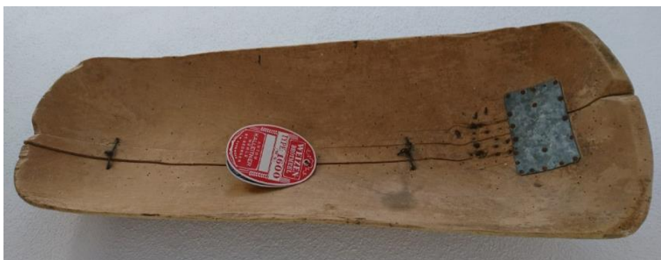
Beispiel für einfache Reparaturen an einer Mehlschaufel, Foto: Österreichisches Ökologie-Institut
