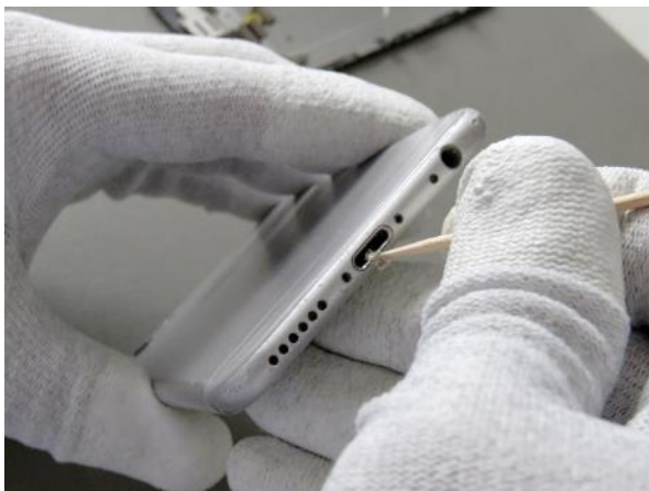
Reinigung von verschmutzten Ladebuchsen und Anschlüssen
