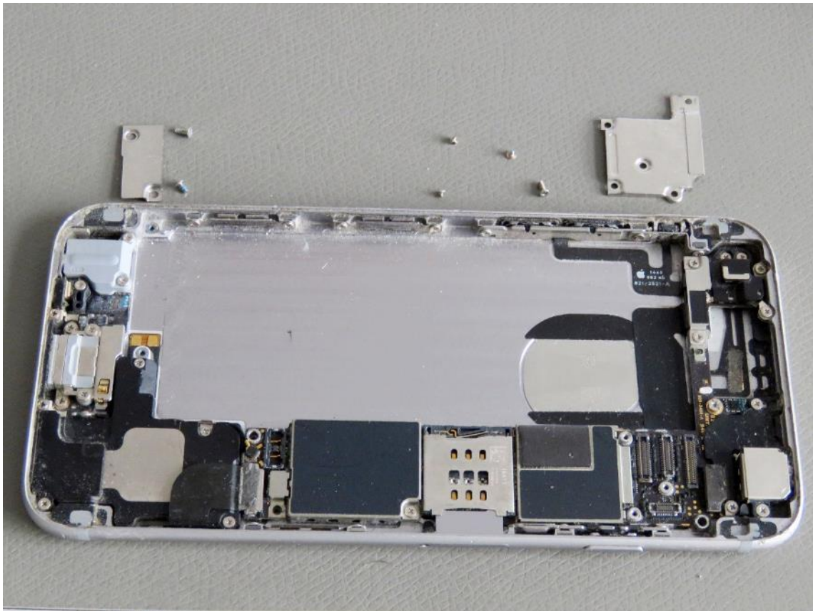
Display von innen betrachtet, Akku entnommen, Befestigungsplatten und Schrauben
